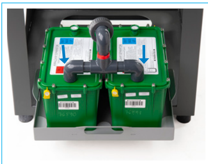
Abb. 129 Tropfwanne in die Tankeinheit schieben
